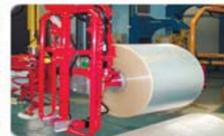
Манипулятор с раздвижным патроном и наклоном на 90 градусов для захвата за внутреннее отверстие.
