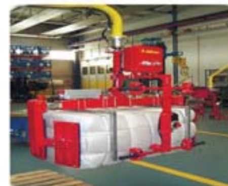
Манипулятор для перемещения тюков с клещевым захватом.
