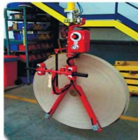
Захват и перемещение рулонов при помощи вил.
