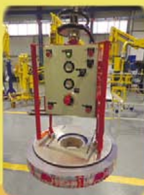
Захват рулона вакуумным присосом.
