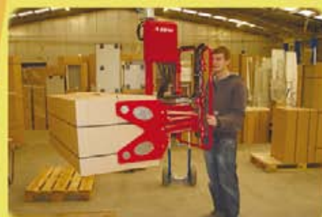
Захват и перемещение коробок клещевым захватом.
