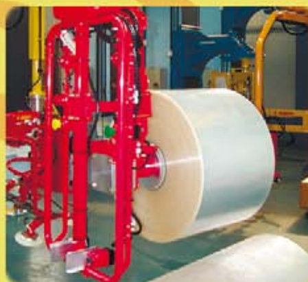
Манипулятор с раздвижным патроном и наклоном на 90 градусов для захвата за внутреннее отверстие.
