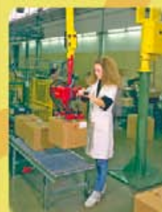
Захват и перемещение коробок за их поверхность.
