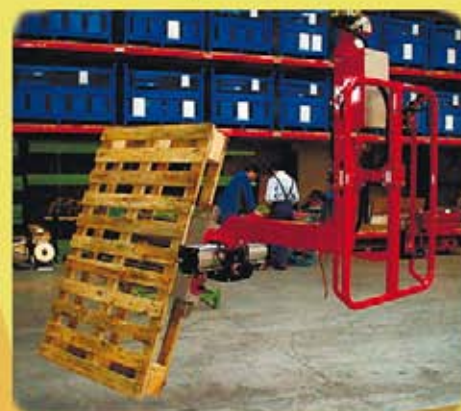
Захват и перемещение паллет с переворотом на 180 градусов.
