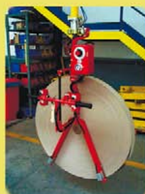
Захват и перемещение рулонов при помощи вил.
