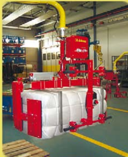
Манипулятор для перемещения тюков с клещевым захватом.
