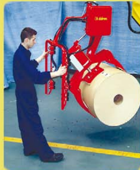
Манипулятор для захвата рулона за наружный диаметр.
