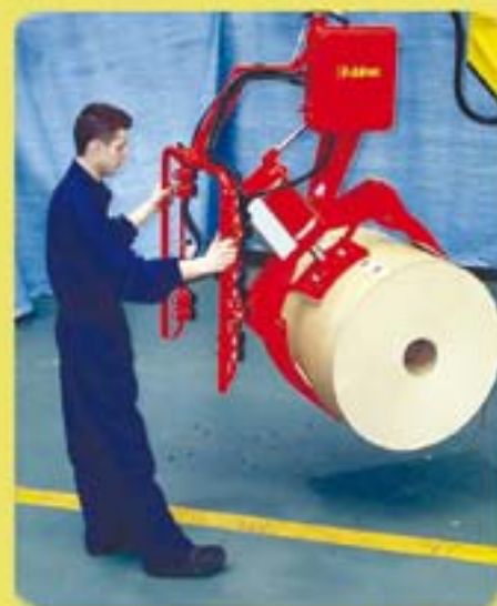
Манипулятор для захвата рулона за наружный диаметр.
