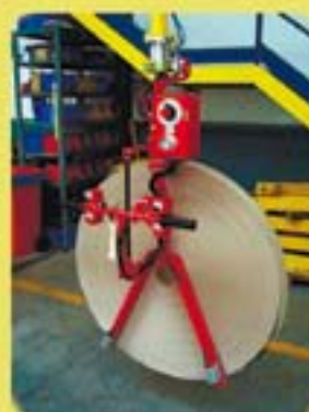
Захват и перемещение рулонов при помощи вил.
