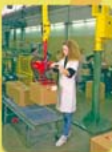
Захват и перемещение коробок за их поверхность.
