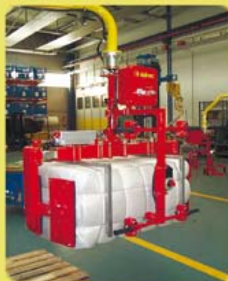
Манипулятор для перемещения тюков с клещевым захватом.
