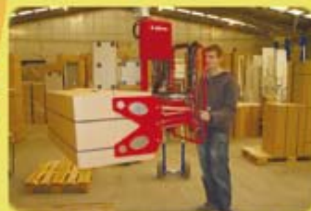
Захват и перемещение коробок клещевым захватом.
